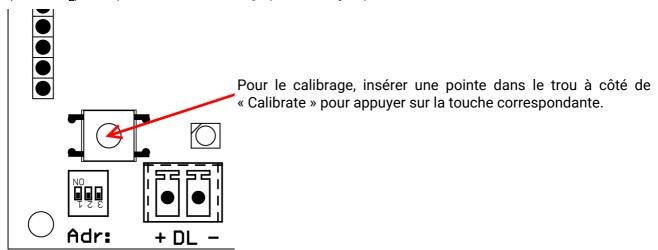
Pendant toute la durée du calibrage, l'index 5 du bus DL indique **4** (statut). De plus, la progression du calibrage entre 0 et 100 % est affichée dans l'index 1.
