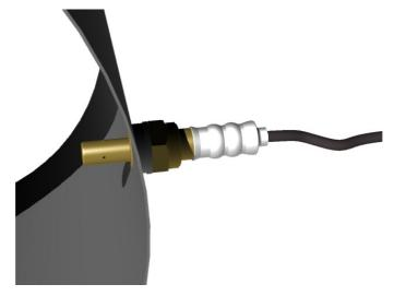
En cas d'utilisation comme capteur de gaz de fumée, le capteur doit être installé le plus droit et à l'horizontale possible dans le tube des gaz de fumée.
