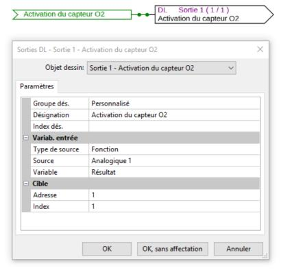
**Exemple:** activation d'une sonde Lambda-DL avec l'adresse DL 1 via l'index 1.
