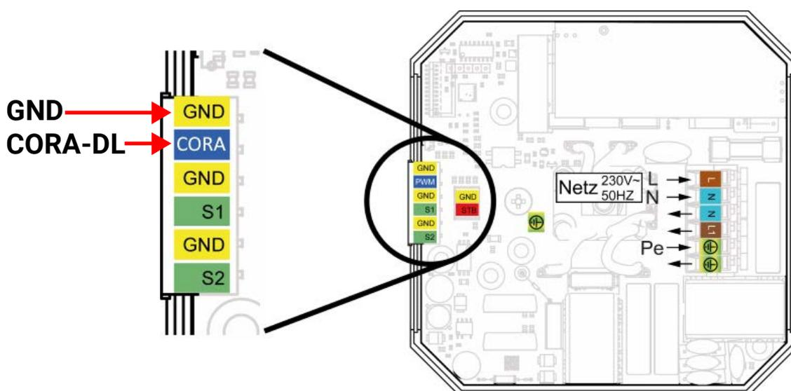
Prestare attenzione alla polarità. Il collegamento **CORA** della resistenza elettrica al regolatore viene effettuato tramite **DL**, quindi **GND** con **GND**.
