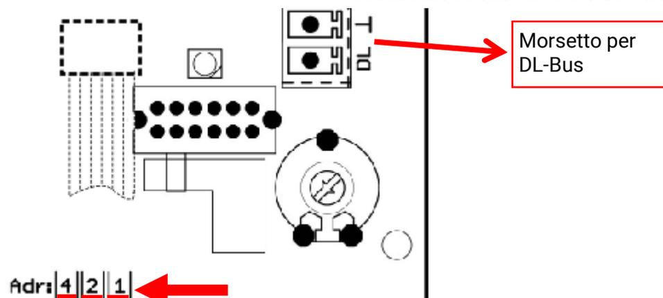
Binari dei conduttori separabili sulla scheda per la determinazione dell'indirizzo del sensore
