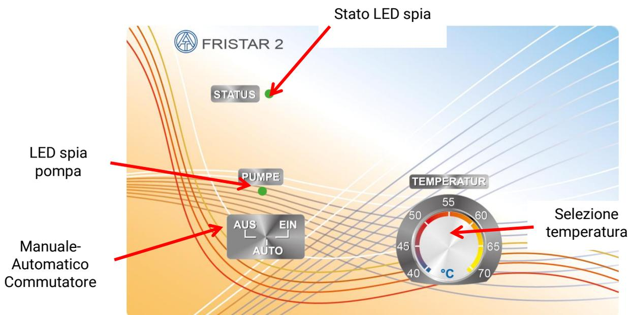
La selezione della temperatura sul regolatore Fristar è possibile solo se non è stato preimpostato alcun valore nominale da un regolatore UVR16x2 o RSM 610 sul Bus DL.
