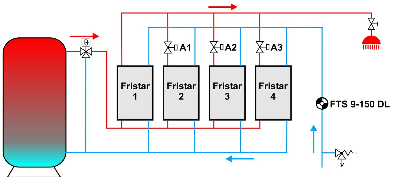
Le definizioni di uscita per le valvole di blocco **A1 - A3** si riferiscono al regolatore UVR61-3R o UVR63.
