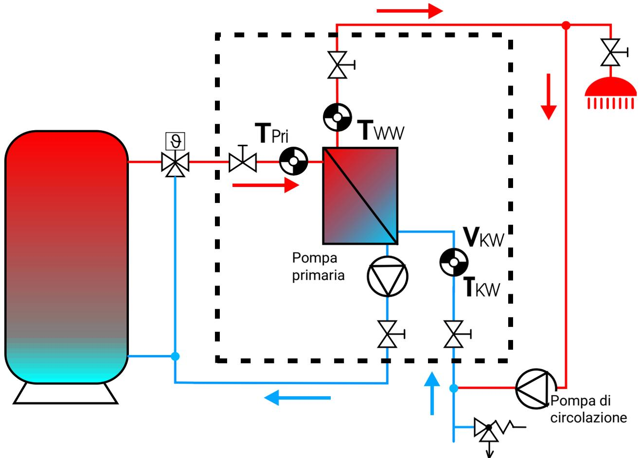
All'accensione della pompa di circolazione, il sensore V<sub>KW</sub> misura un flusso e autorizza la pompa primaria.
