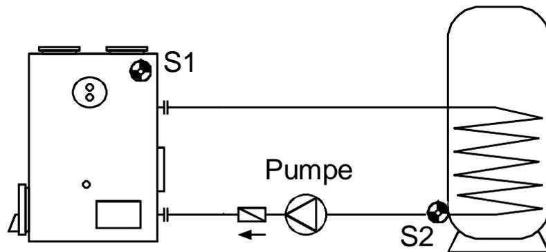
Die Pumpe läuft, wenn Sensor **S1** größer als die Schwelle **min** ist und Sensor **S1** um die Differenz **diff** höher ist als Sensor **S2**.
