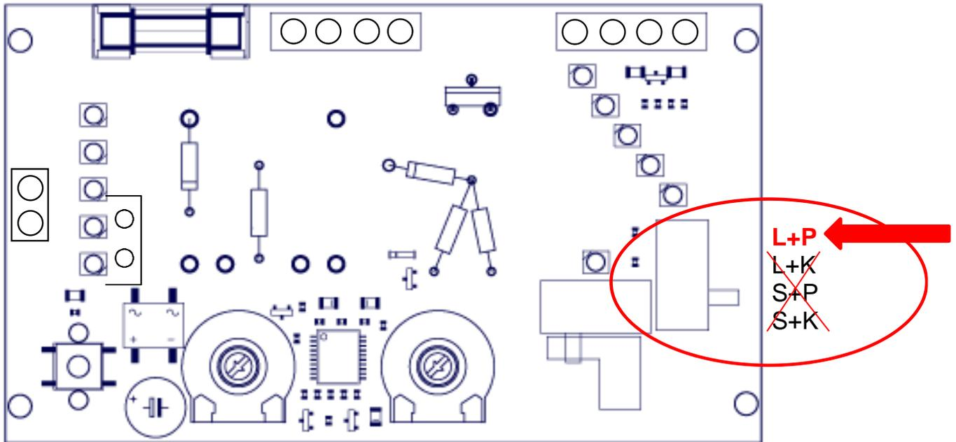
Die Wahl erfolgt über einen Schiebeschalter am rechten Rand der Platine. Auf den Schiebeschalter kann von außen nicht zugegriffen werden.
