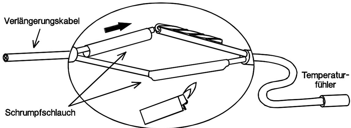
Um Messwertschwankungen zu vermeiden ist für eine störungsfreie Signalübertragung darauf zu achten, dass die Sensorleitungen keinen äußeren negativen Einflüssen ausgesetzt sind. Bei Verwendung von nicht geschirmten Kabeln sind Sensorleitungen und 230V-Netzleitungen in getrennten Kabelkanälen und mit einem Mindestabstand von 5 cm zu verlegen. Werden geschirmte Leitungen verwendet, so muss der Schirm mit der Sensormasse verbunden werden.
