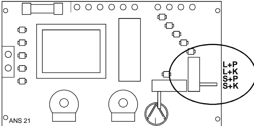
La selección se realiza a través de un conmutador deslizante que se encuentra en el borde derecho de la platina. No se puede acceder desde el exterior al conmutador deslizante.
