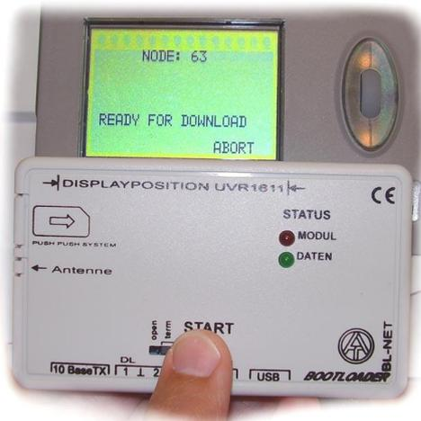
**Position du BL-NET au niveau du régulateur en cas de transmission de données via infrarouge :**
