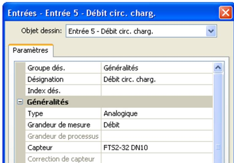
Le débit volumique du **capteur sur VT1** est mesuré au niveau de l'**entrée 5** (**exemple** : capteur FTS2-32).
