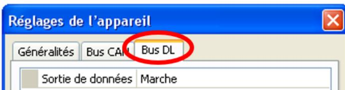
Dans le menu Fichier / Réglages / Réglages de l'appareil / Bus DL, il est possible d'activer ou de désactiver la **sortie** de données pour l'**enregistrement de données** via le bus DL et pour l'affichage dans le capteur ambiant **RAS+DL**.
