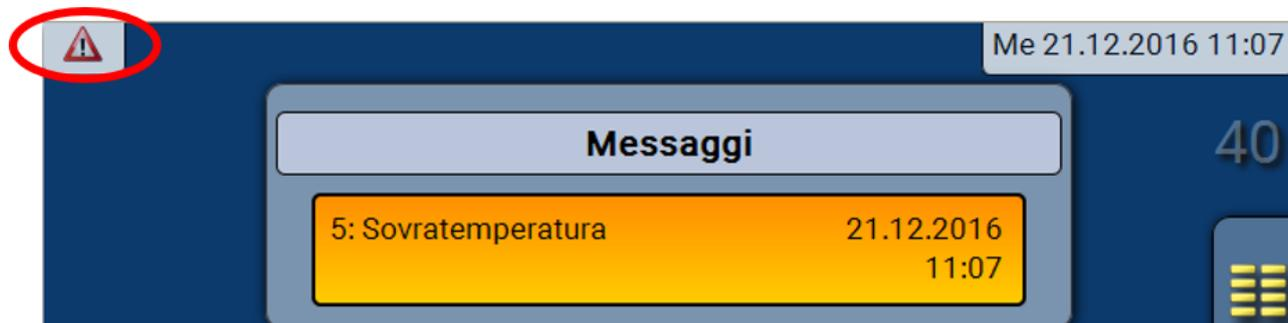
Se è attivo almeno un messaggio, nella riga di stato in alto viene visualizzato un triangolo di avvertenza.
