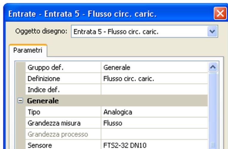
Il flusso volumetrico del **sensore su VT1** viene misurato sull'**entrata 5** (**esempio**: sensore FTS2-32).
