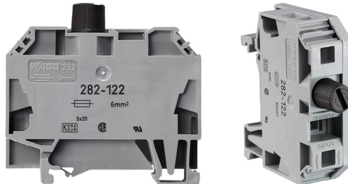
Die Sicherungsklemme SKL5x20 (samt 6,3A flink Sicherung) dient zur externen Absicherung des Reglers UVR610. Die interne Sicherung der UVR610 kann nur im Werk des Herstellers getauscht werden. Durch Anschluss der Sicherungsklemme an **L1** wird die interne Sicherung des Geräts überbrückt. Die Sicherung in der Sicherungsklemme kann einfach vor Ort getauscht werden.
