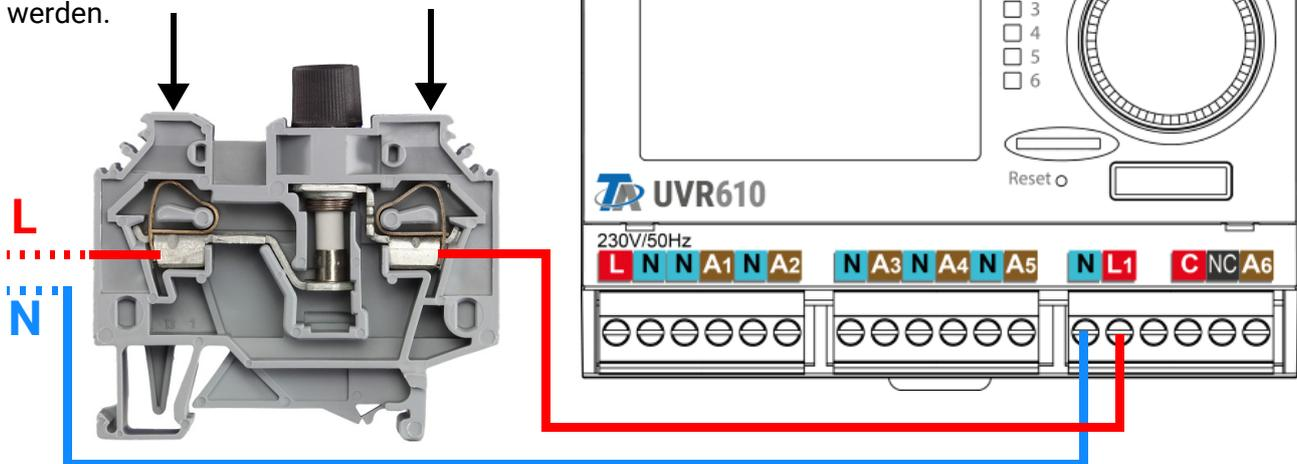
Die Sicherungsklemme wird an **L1** angeschlossen. Die Richtung laut Anschlussgrafik muss beachtet werden (siehe Aufdruck „INPUT“ an der Oberseite).
