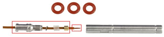
Attorcigliare il cavo per adattarlo al cono della bussola di contatto e all'interno del corpo della sonda. L'obiettivo di questa deformazione consiste nell'ottenere il contatto superficiale massimo con I corpo della sonda.
