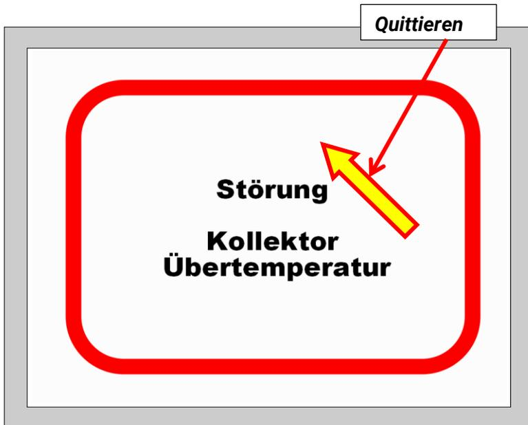
Wurden eine oder mehrere Meldungen programmiert, so wird beim Auftreten einer Meldung eine **Pop-Up-Seite** eingeblendet.
