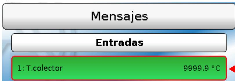
La visualización del sensor está enmarcada en rojo = error
