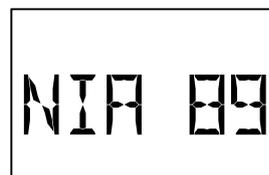
Livello analogico Visualizzato solo con uscita di comando = attiva
