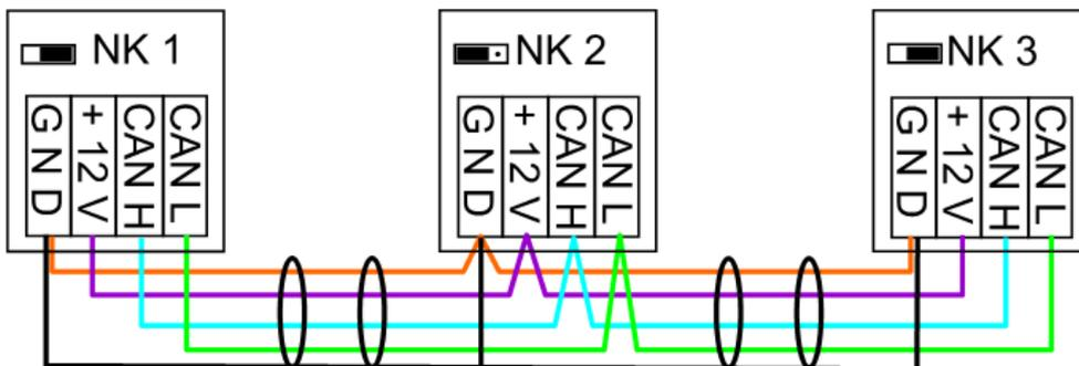
Jedes CAN-Netzwerk ist beim ersten und letzten Teilnehmer im Netzwerk mit einem 120 Ohm Busabschluss zu versehen (= **Terminierung**). Das erfolgt mit einer Steckbrücke **auf der Rückseite des Reglers**). In einem CAN-Netzwerk sind also immer zwei Abschlusswiderstände (jeweils am Ende) zu finden. Stichleitungen oder sternförmige CAN-Verdrahtung sind nicht zulässig!
