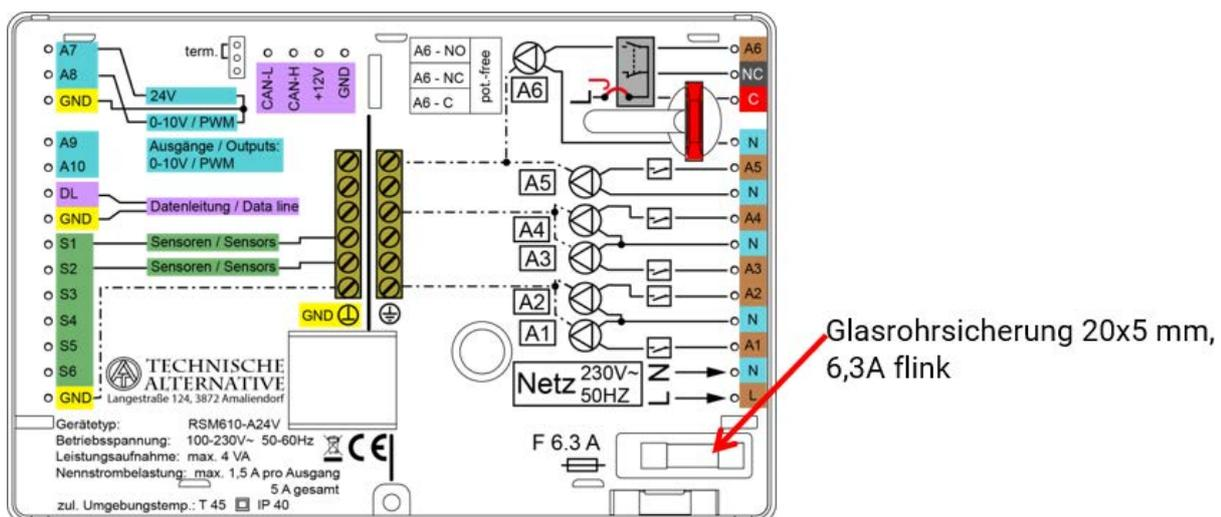
**Realistische Temperaturwerte, aber ein Fehlverhalten der Ausgänge** deuten auf falsche Einstellungen oder Klemmung hin. Lassen sich die Ausgänge im Handbetrieb EIN und AUS schalten, ist das Gerät funktionsfähig und es sollten alle Einstellungen sowie die Klemmung überprüft werden.
