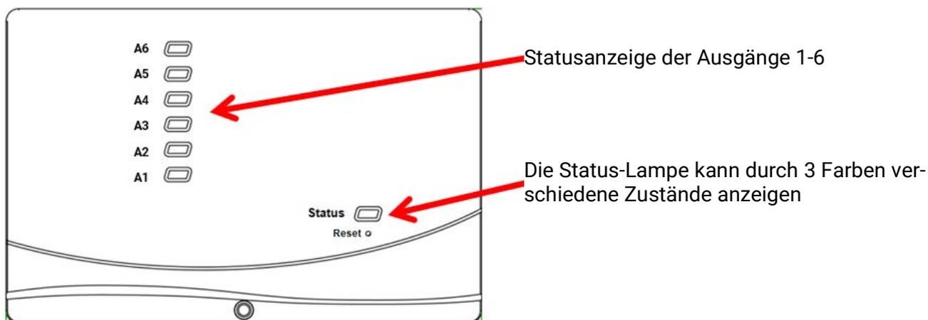
Eine aktive **Meldung** kann durch eine geänderte Status-Anzeige angezeigt werden. Die Einstellung dafür erfolgt im **Parametermenü** der Funktion „**Meldung**“.
