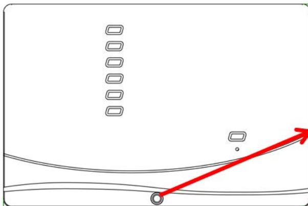
Die Schraube an der Vorderseite lösen und den Deckel abheben.
