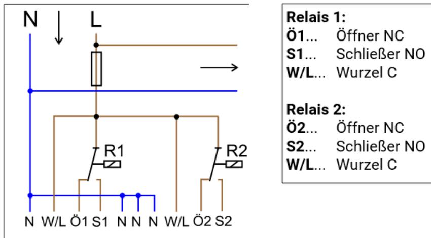
Die beiden Relais-Ausgänge werden durch die Sicherung auf dem Relaismodul abgesichert. Die Klemme „W“ entspricht daher dem Außenleiter „L“.
