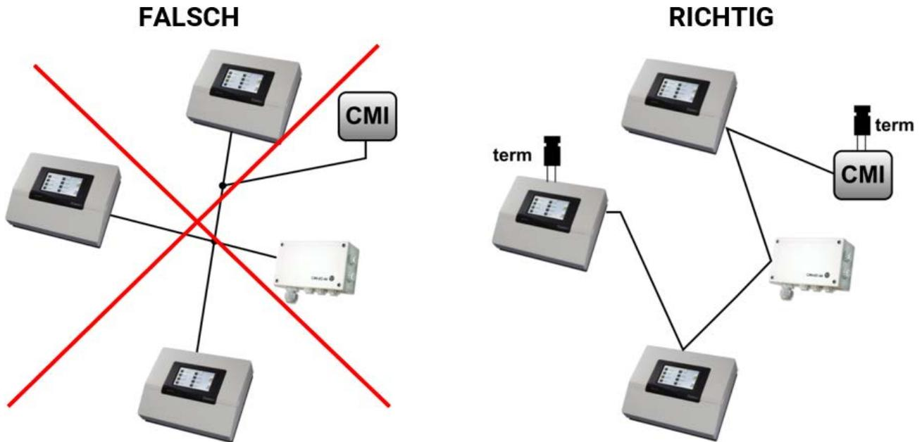
**Beispiel:** Verbinden dreier Netzwerkknoten (NK) mit 2x2poligem Kabel und **Terminieren** der abschließenden Netzwerkknoten (Netzwerk innerhalb eines Gebäudes)
