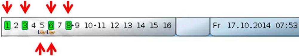
Der Ausgang 5 wurde händisch **ausgeschaltet** (Hand/AUS), der Ausgang 6 händisch **eingeschaltet** (Hand/EIN). Ausgänge, die auf Hand/AUS oder Hand/EIN geschaltet wurden, werden mit einem **Handsymbol** unterhalb der Ausgangsnummer gekennzeichnet.
