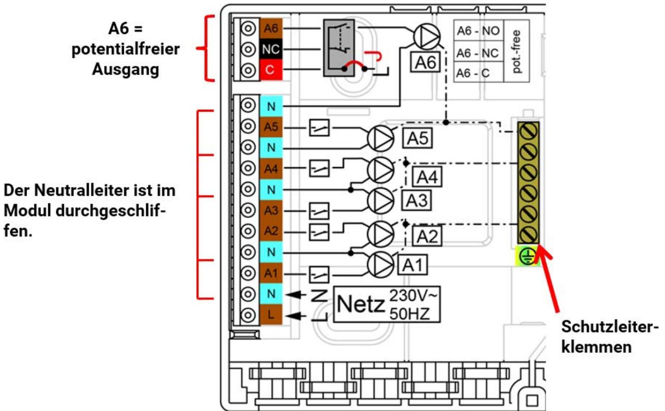
Die maximale Strombelastung der Ausgänge ist den **technischen Daten** zu entnehmen.
