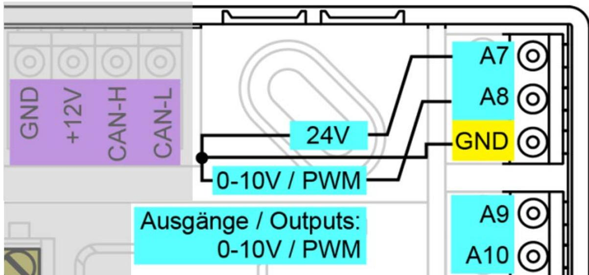
Zur Versorgung von externen Geräten mit 24V= steht der Ausgang A7 zur Verfügung. Die Gesamtlast aller Geräte mit 12V- und 24V-Versorgung darf zusammen **nicht mehr als 6 Watt** betragen.
