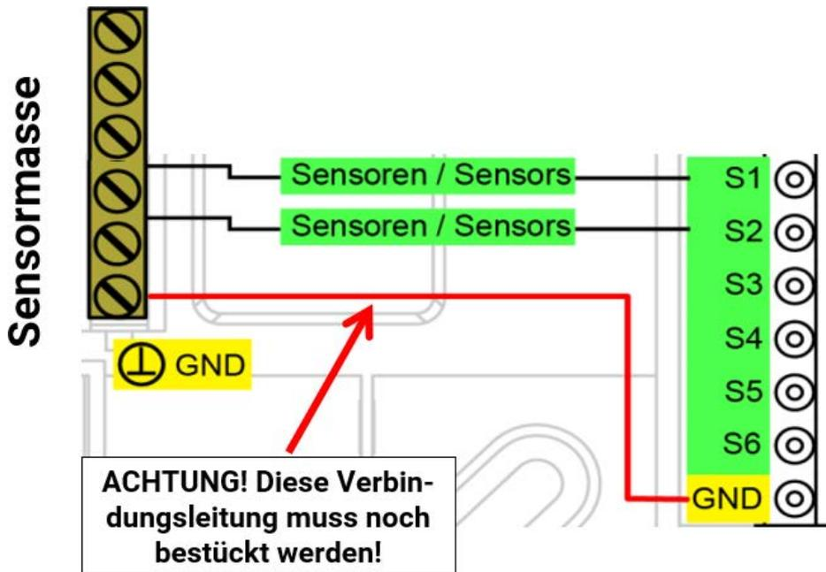
Der Anschluss der Sensoren erfolgt immer zwischen dem jeweiligen Sensoranschluss (S1 – S6) und der Sensormasse (GND). Im Sockel befindet sich eine Masseleiste, zu der vor der Klemmung der Sensoren eine Verbindung zur Klemme GND gelegt werden muss.
