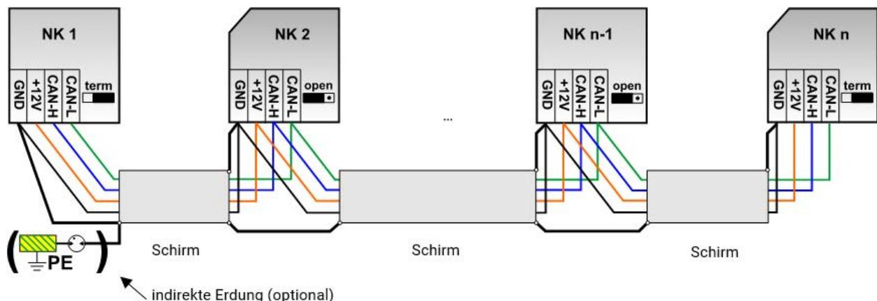
Max. Leitungslänge: 1.000m bei 50 kbit/s
