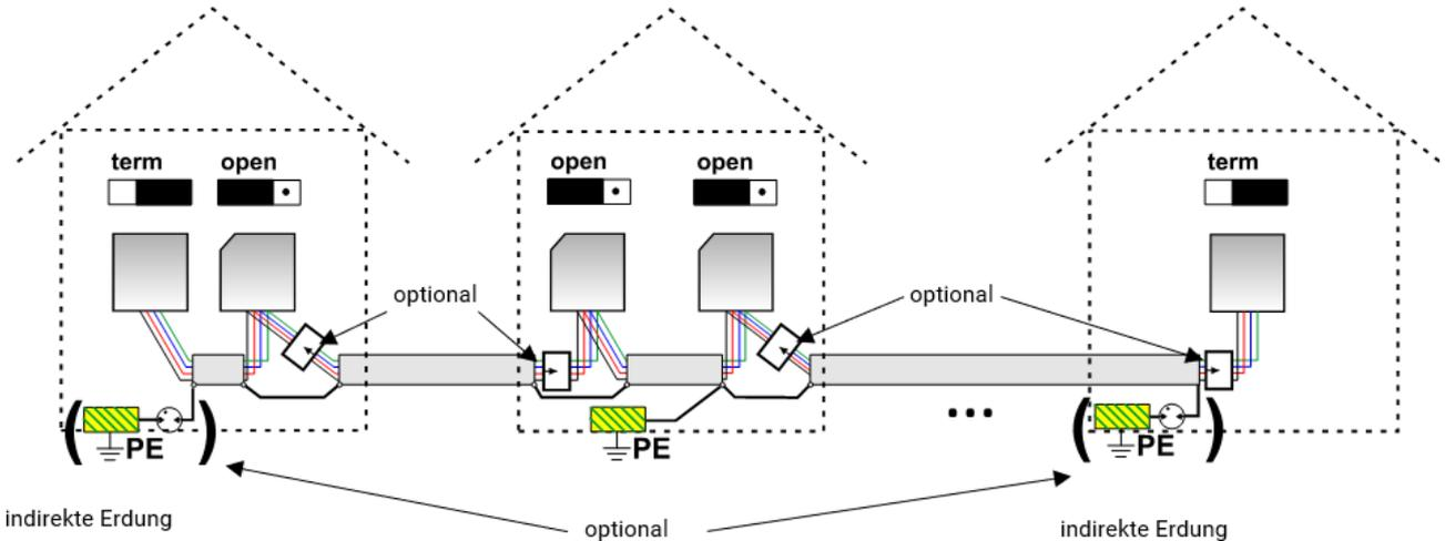
Max. Leitungslänge: 1.000m bei 50 kbit/s
