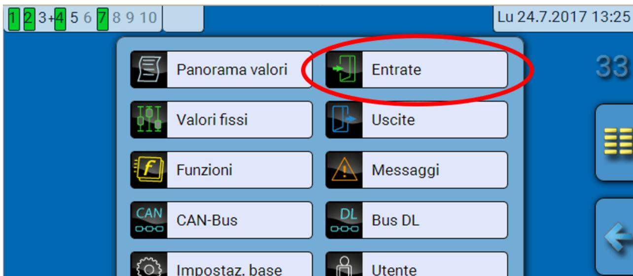
Selezionandole nel menu principale, le entrate vengono visualizzate con la relativa definizione e l'attuale valore di misura ovvero stato.
