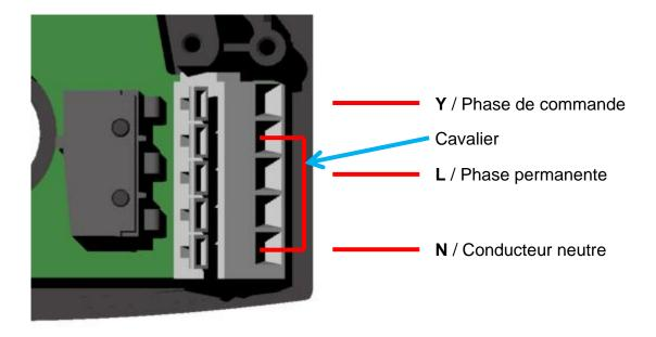
La commutation peut également se déclencher par une **tension externe**, s'il est impossible de garantir que la phase de commande **Y** possède le même angle de phase (L1, L2, L3) que la phase permanente ou provient du même circuit électrique :
