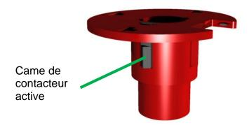
Si la came de contacteur déjà détachée n'est plus utile, il est possible de l'insérer à 180° dans la rainure, de manière à ce que le commutateur de fin de course ne puisse plus être actionné :
