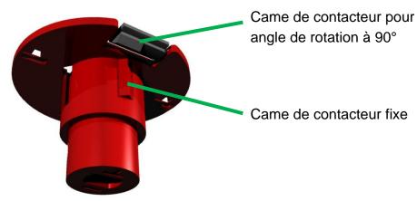
Pour un angle de manœuvre de 90°, il convient d'insérer une 2e came de contacteur dans l'arbre. Pour ce faire, détacher cette came de contacteur (identifiée en gris sur les dessins) de la rondelle et la pousser dans la rainure prévue à cet effet.
