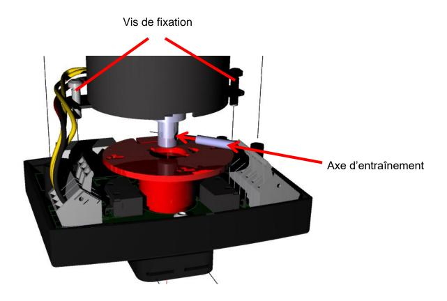
Le moteur est déjà connecté aux bornes de moteur en usine. Ces raccords ne doivent pas être permutés.
