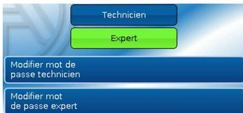
L'**expert** peut modifier les mots de passe du technicien et de l'expert. Le **technicien** peut uniquement modifier le mot de passe du technicien. La longueur du mot de passe et le type des caractères peuvent être choisis au gré de chacun.
