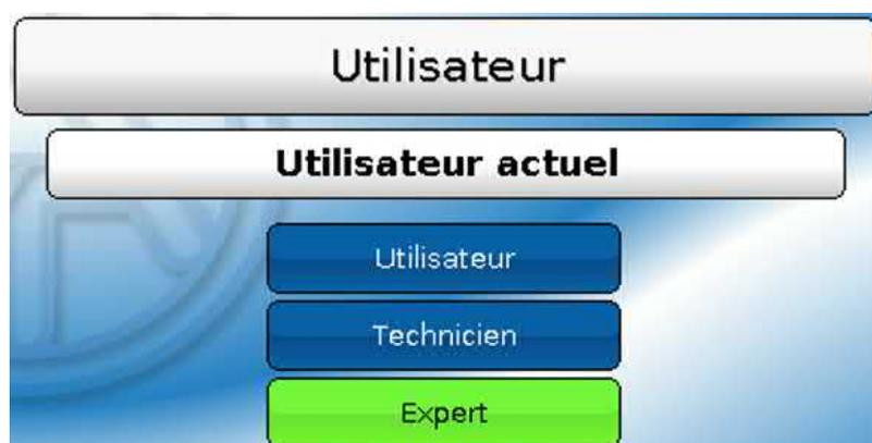
Sélection déterminant si l'utilisateur a le niveau **Expert**, **Technicien** ou **Utilisateur**.
