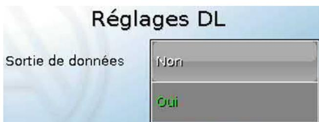
Ce bouton permet d'activer ou de désactiver la **sortie** de données pour l'**enregistrement de données** via le bus DL et pour les affichages dans le capteur ambiant **RAS-PLUS**. Le C.M.I. est utilisé pour l'**enregistrement de données DL**. Seules les valeurs d'entrée et de sortie ainsi que 2 calorimètres sont transmis, mais aucune valeur des entrées réseau.
