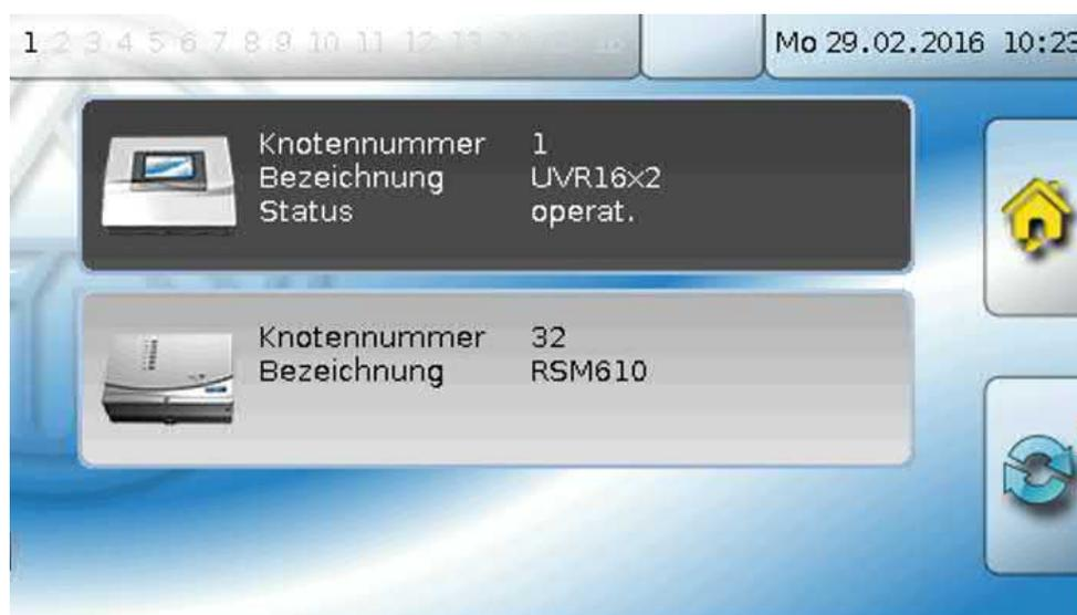
Les nœuds CAN actifs dans le réseau de bus CAN s'affichent après effleurement du champ. **Statut** permet d'afficher le statut du bus CAN du régulateur. Le statut change automatiquement après le démarrage du régulateur de *init.* → *préop(érationnel)* → *opérat(ionnel)*. Ce n'est qu'après que la communication avec les autres appareils à bus CAN est possible.
