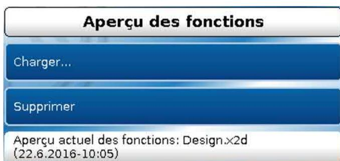
L'Aperçu des fonctions (fichier \*.x2d, version du programme **TA-Designer minimum : 1.15**) peut être chargé dans l'appareil à partir de la carte SD, ou être supprimé dans l'appareil. Il est possible d'enregistrer plusieurs fichiers sur la carte SD.
