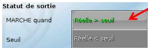
Pour la valeur **Statut de la sortie**, il est possible d'indiquer si le statut **MARCHE** doit être transmis au-dessus ou au-dessous d'un **seuil** réglable
