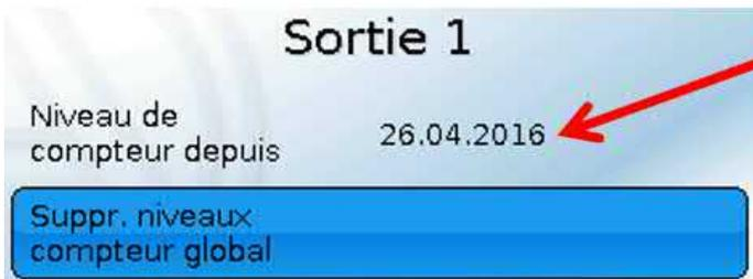
Après l'effleurement du champ de commande, le système demande s'il faut effacer **tous** les niveaux de compteur ainsi que **Veille** des compteurs d'heures de service **et** d'impulsions. Les niveaux de compteur **Aujourd'hui**, **Dernier service** et **Service actuel** ne sont **pas** effacés.
