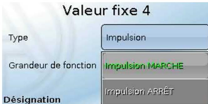
Sélection de la **grandeur de fonction** : lors de l'activation, une impulsion MARCHE (de ARRÊT sur MARCHE) ou une impulsion ARRÊT (de MARCHE sur ARRÊT) est générée au choix.
