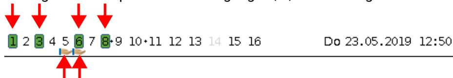
Der Ausgang 5 wurde händisch **ausgeschaltet** (Hand/AUS), der Ausgang 6 händisch **eingeschaltet** (Hand/EIN). Ausgänge, die auf Hand/AUS oder Hand/EIN geschaltet wurden, werden mit einem **Handsymbol** unterhalb der Ausgangsnummer gekennzeichnet.
