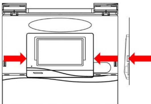
b) Mit zwei großen Schraubendrehern die beiden Rastkralle drücken (Pfeile in Skizze links) und das Gerät aus der Konsole hebeln.
