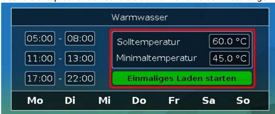
Die Anforderung Warmwasser kann über ein Zeitprogramm der Funktion **Schaltuhr** zwischen zwei Solltemperaturen umgeschaltet werden. Die **Solltemperatur** gilt innerhalb, die **Minimaltemperatur** außerhalb der Zeitfenster.
