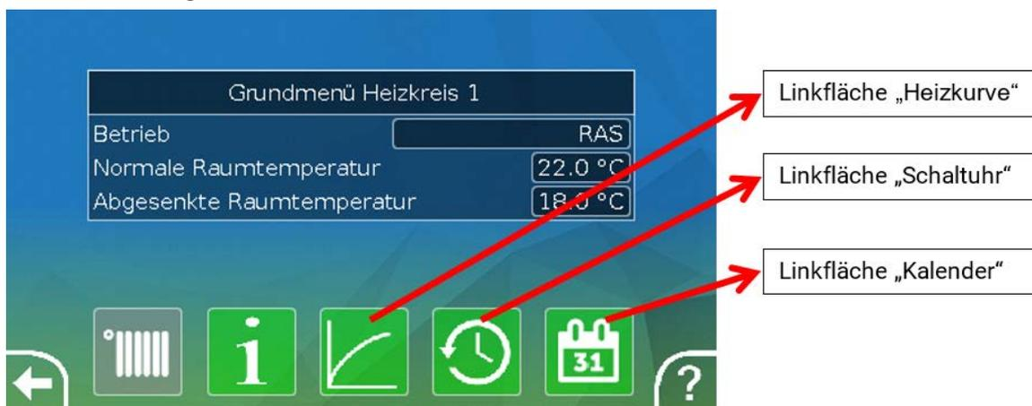
**Betriebsart** zeigt die aktuell aktive Betriebsart an. Die Betriebsart wird von der Regler-Einstellung „Betrieb“, der Kalenderfunktion, der Wartungsfunktion, des Status „Fensterkontakt“ oder des Status „Externer Schalter“ festgelegt. Je nach Zustand dieser Funktionen oder Eingangsvariablen kann daher die Betriebsart von der internen Einstellung „Betrieb“ abweichen.
