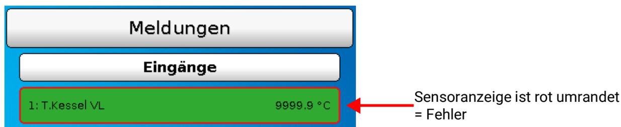
Der Sensor 1 zeigt eine Unterbrechung (Sensordefekt oder Kabelunterbrechung) durch die Anzeige 9999,9°C an. Bei Anzeige von -9999,9°C hätte der Sensor oder das Sensorkabel einen Kurzschluss.
