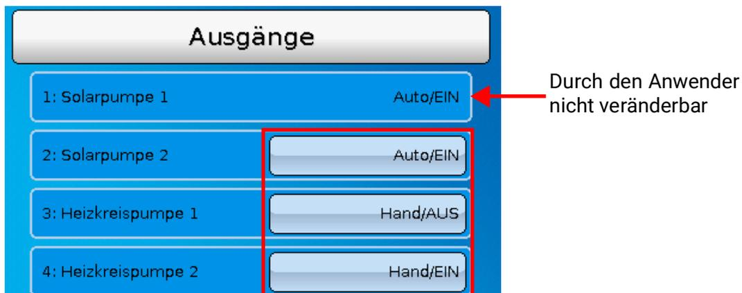
Ausgänge, deren Ausgangsstatus durch den Anwender geändert werden können, werden durch Antippen des Statusfeldes geändert.
