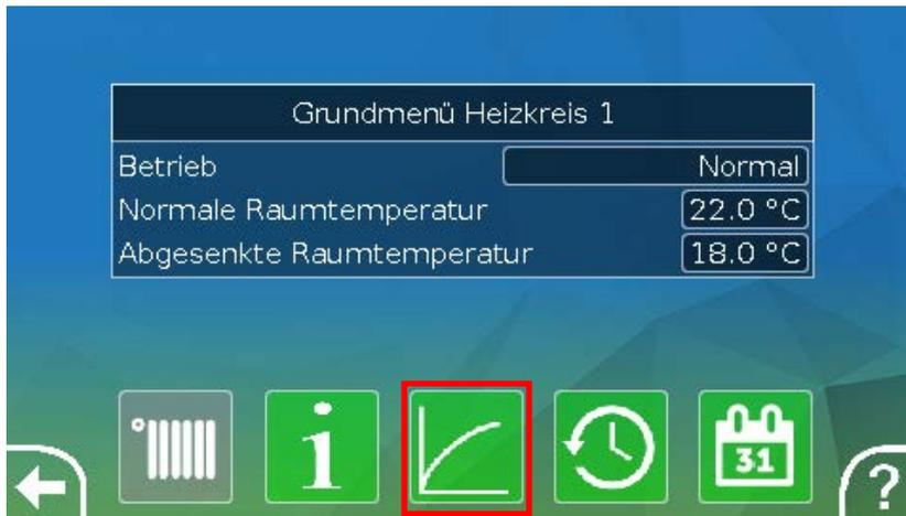
Unter **Betrieb** kann die **interne** Betriebsart der Funktion geändert werden. „RAS“ zeigt an, dass die Einstellung des Raumsensors übernommen wird. Ist kein Raumsensor montiert, dann übernimmt der Heizkreis bei Einstellung „Zeit/Auto“ das Zeitprogramm der Schaltuhr. Zur Auswahl stehen außerdem „Normal“ (= Dauer-Heizbetrieb), „Abgesenkt“ (= Dauer-Absenkbetrieb) oder „Standby/Frostschutz“ (= Ausschalten des Heizkreises unter Berücksichtigung der programmierten Frostschutzbedingungen).
