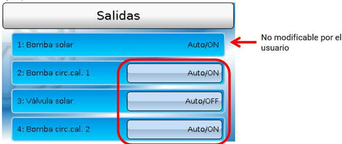
Las salidas cuyo estado de salida puede ser modificado por el usuario se pueden modificar tocando el campo de estado.
