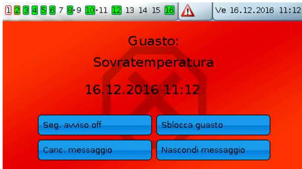
**Esempio:** messaggio di tipo "Avviso", uscita 1 dominante OFF, uscita 2 dominante ON, Segn. avviso attivato, uscita per Segn. avviso: uscita 12.
