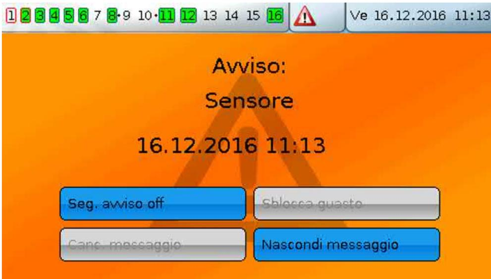
**Esempio:** messaggio di tipo "Messaggio", uscita 1 dominante OFF, uscita 2 dominante ON, Segn. avviso attivato, uscita per Segn. avviso: uscita 12.
