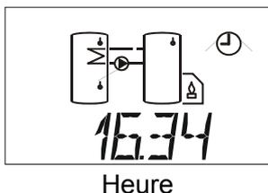
**ATTENTION** : Même si les fenêtres horaires ne sont pas utilisées, le réglage correct de la date et de l'heure peut se révéler judicieux. Si un enregistrement de données est effectué à l'aide d'un enregistreur de données (D-LOGG ou BL-NET), une assignation des données en fonction du temps n'est possible qu'avec la date et l'heure correctes.
