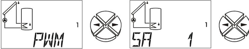
**SA** Réglage des sorties pour l'autorisation de la sortie de commande.
