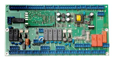
Componente de potencia UVR 1611E-NP con módulo de procesador
