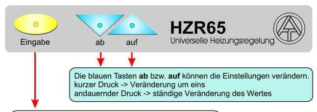
Ohne Tastendruck wird jener Wert angezeigt, der dem Wahlschalter am nächsten ist (zB. T2) Druck auf die gelbe Taste "Eingabe" bewirkt die Anzeige des zweiten Wertes (zB. min2)
