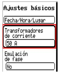
En el menú **Ajustes básicos** se encuentra el punto **transformador.** Indica tipos transform. usados (50/100/400A).
