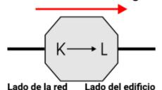
Cada transformador de corriente externo lleva la inscripción «K -> L», con lo que para el recuento positivo se necesita que la dirección de la energía vaya de K a L.
