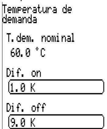
La demanda se realiza con  $T.\text{dem. nominal} + \text{Dif. on}$  (= 61 °C); la desconexión, con  $T.\text{dem. nominal} + \text{Dif. off}$  (= 69 °C).
