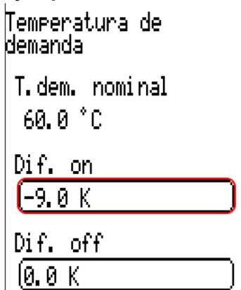
La demanda se realiza aquí con  $T.\text{dem. nominal} + \text{Dif. on}$  (= 51 °C); la desconexión, con  $T.\text{dem. nominal} + \text{Dif. off}$  (= 60 °C).
