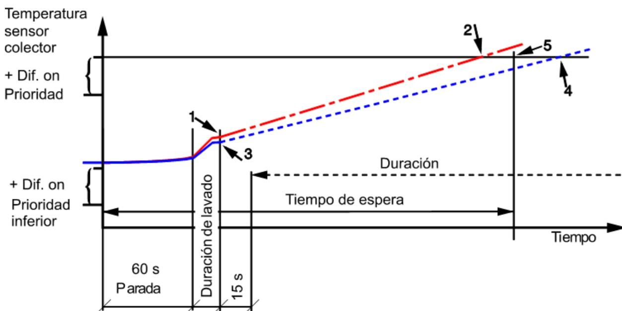
Durante la carga en el consumidor de prioridad inferior, el aparato controla la temperatura del colector. Si, con la bomba en funcionamiento, la temperatura del colector vuelve a alcanzar la diferencia de **conexión** (colector – referencia) del consumidor **actualmente** conectado, se activará el temporizador de prioridad. Si se utiliza un sensor de radiación, la radiación debe superar un valor umbral en lugar de la diferencia de temperatura.
