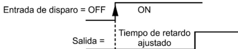
**Duración mínima de marcha:** La señal ON de la entrada de disparo conecta inmediatamente la salida. Si la entrada se desactiva durante el tiempo mínimo de marcha (OFF), a pesar de ello la salida permanece conectada hasta que el tiempo mínimo de marcha haya transcurrido. Si la entrada de disparo permanece en estado ON una vez transcurrido el tiempo mínimo de marcha, la salida se queda conectada.
