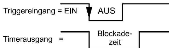
Ajuste «**Redisparo = Sí**»: Si dentro del tiempo de bloqueo se ajusta la entrada de disparo a ON, vuelve a iniciarse el tiempo de bloqueo cuando la entrada de disparo se ajusta de nuevo a OFF **dentro del tiempo de bloqueo original**.
