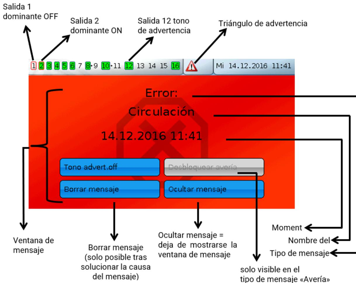
Si se ha ocultado la ventana de mensaje, se puede volver a mostrar seleccionando el **triángulo de advertencia** en la barra de estado.
