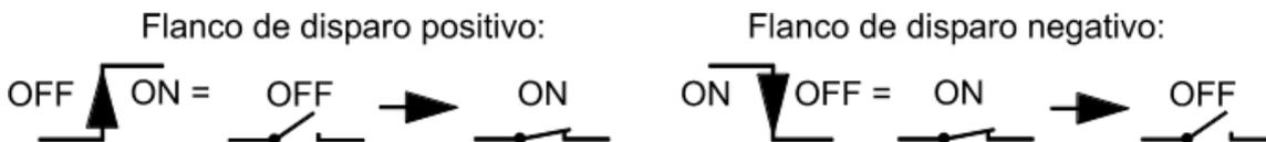
**Tiempo marcha inercia:** La señal ON de la entrada de disparo conecta **inmediatamente** la salida. Si se desactiva la entrada (OFF), la salida permanece en ON por el periodo equivalente al tiempo de marcha de inercia.
