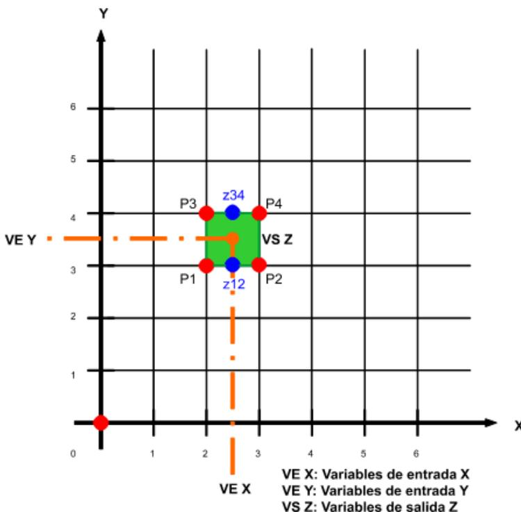
Para el cálculo del valor Z, primero se calculan los 2 valores medios entre P1 y P2 ( $z_{12}$ ) y entre P3 y P4 ( $z_{34}$ ). A partir de estos dos valores medios ( $z_{12}$  y  $z_{34}$ ) se calcula un nuevo valor medio, que se indicará como variable de salida Z.
