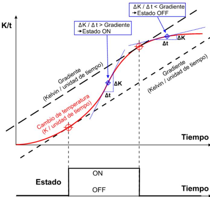
El estado pasa a ON cuando el aumento de temperatura, **dentro de la décima parte de la unidad de tiempo** ajustada, es mayor que el gradiente ajustado. El ajuste «Diferencia» en las variables de entrada no debería estar por debajo de 2,0 K, ya que, de lo contrario, las fluctuaciones de los valores de medición pueden adulterar el resultado.
