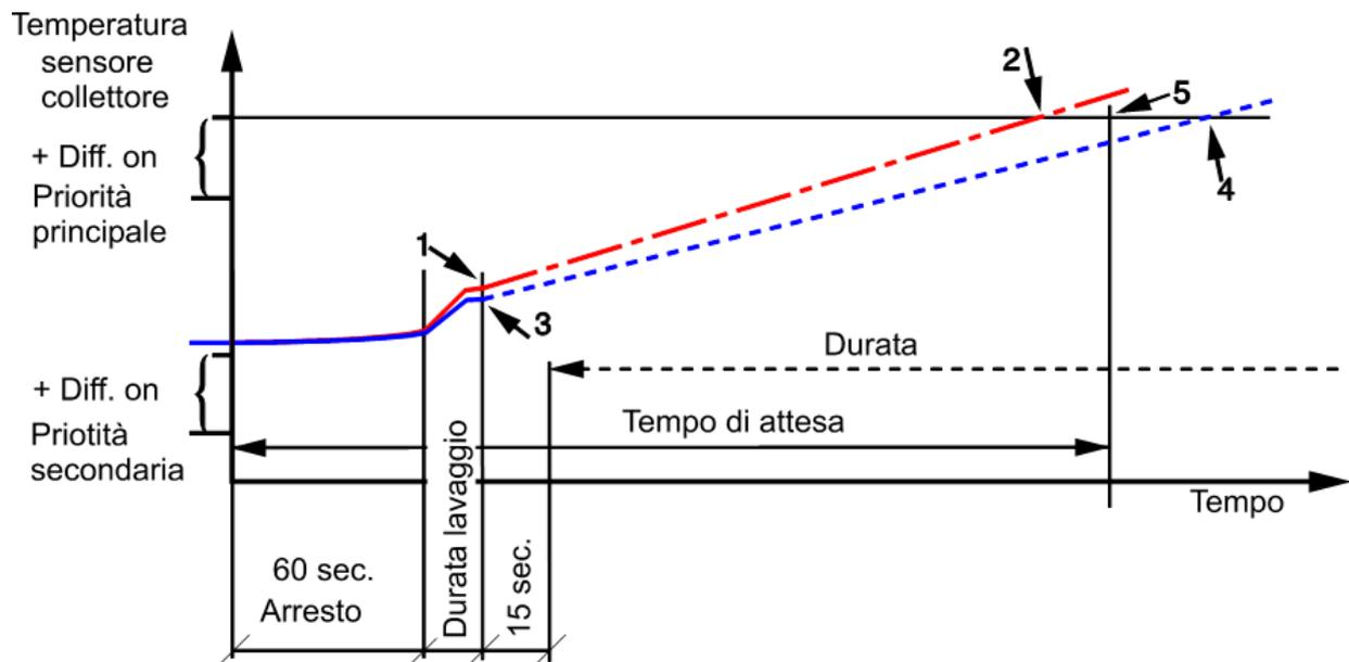
Durante il caricamento nell'utenza con priorità secondaria l'apparecchio monitora la temperatura del collettore. Se la temperatura del collettore raggiunge nuovamente - con pompa già in funzione - la differenza di **attivazione** (riferimento collettore) dell'utenza **attualmente** attivata, si attiva il timer di priorità. In caso di utilizzo di un sensore di radiazione, è l'irradiazione, invece della differenza di temperatura, a dover superare un determinato valore soglia.
