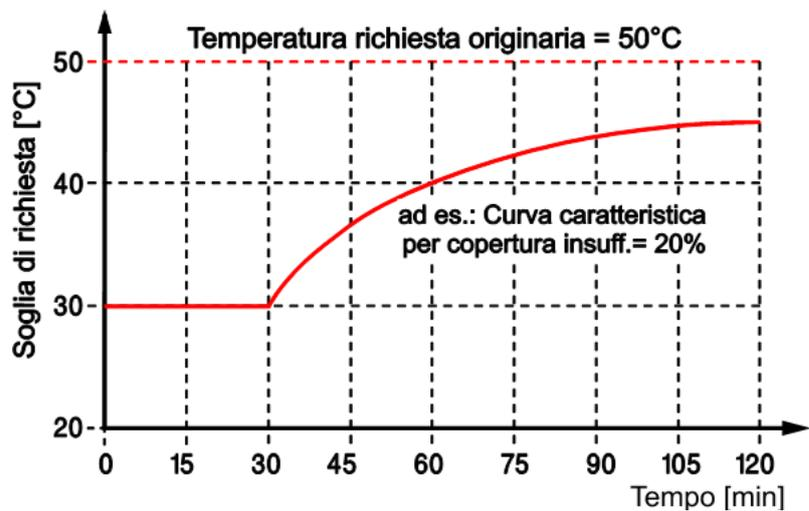
Lo stato della richiesta passa su ON quando per 30 min la temperatura reale di richiesta è inferiore al valore nominale di 20 K, oppure per 1440 minuti (=1 giorno) la temperatura reale di richiesta è inferiore al valore nominale di 0,42 K.
