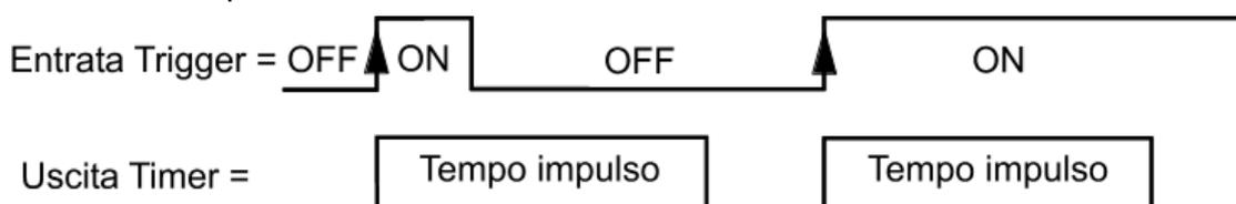
Un fianco trigger **positivo** è la modifica dello stato dell'entrata da "OFF" a "ON" oppure da "Interruttore aperto" a "Interruttore chiuso" (= in chiusura). Questa situazione corrisponde all'esempio sopra riportato.
