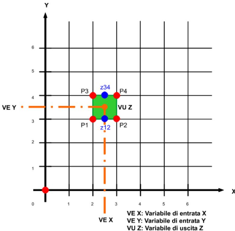
Per il calcolo del valore Z vengono calcolati prima i 2 valori medi tra P1 e P2 ( $z_{12}$ ) ovvero P3 e P4 ( $z_{34}$ ). Da questi due valori medi  $z_{12}$  e  $z_{34}$  viene quindi calcolato un ulteriore valore medio, che viene indicato come variabile di uscita Z.
