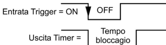
Impostazione "**retrigger = si**": Se all'interno del Tempo di bloccaggio l'entrata trigger viene portata su ON, il tempo di bloccaggio ricomincia, se l'entrata trigger viene riportata nuovamente su OFF **all'interno del tempi di bloccaggio originario**.
