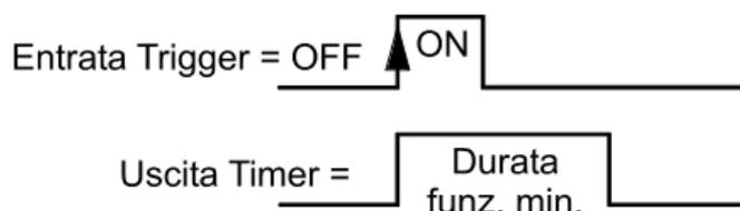
**Tempo bloccaggio:** Il segnale ON sull'entrata trigger riattiva l'uscita solo dopo che, dopo la fine dell'ultimo segnale ON, il Tempo di bloccaggio è terminato.
