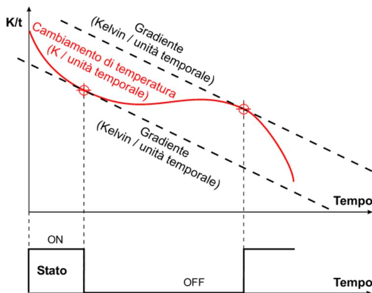
Nel punto in cui la curva del **cambiamento della temperatura** diventa più ripida del gradiente, lo stato passa su ON.
