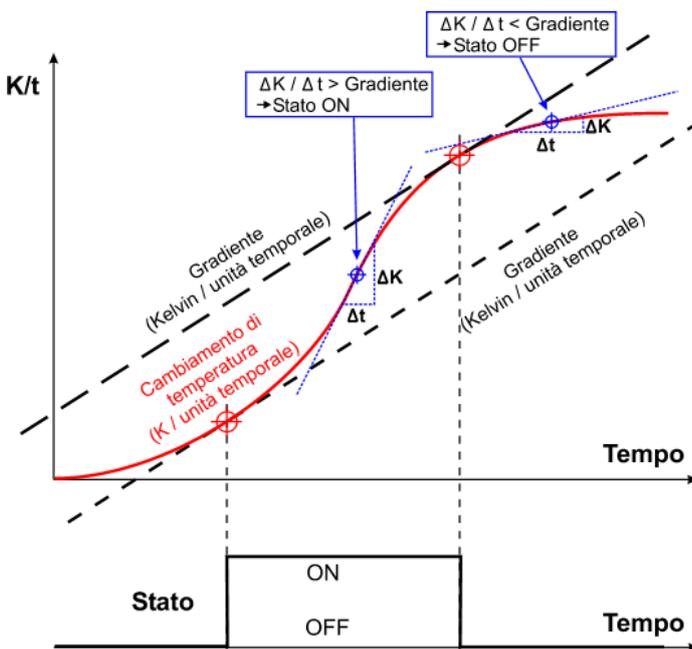
Lo stato passa a ON, quando l'aumento della temperatura è **superiore al gradiente impostato entro un decimo dell'unità temporale** impostata.
