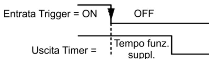
**Tempo di ritardo:** Il segnale ON sull'entrata trigger viene trasmesso all'uscita solo dopo il termine del Tempo di ritardo. Un segnale OFF sull'entrata trigger determina un arresto immediato dell'uscita, al termine del Tempo di ritardo.
