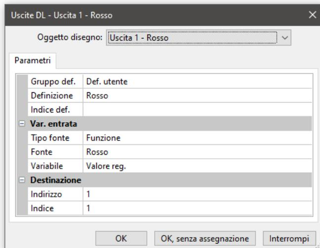
Al dimmer LED vengono assegnati valori per i singoli canali tramite bus DL. A tale scopo, viene parametrizzata un'uscita **DL-Bus**, che trasmette un valore analogico.
