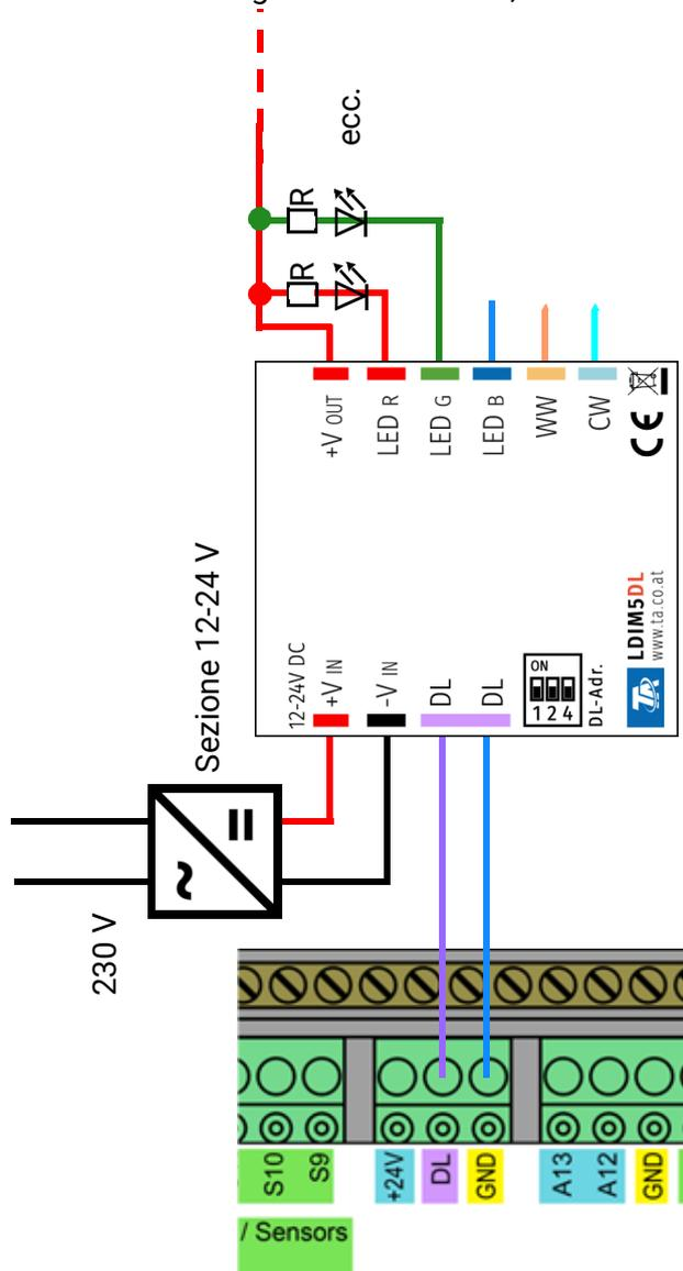
Con l'uso previsto sopra vengono controllati i 5 canali di colori di una singola striscia LED. I 5 canali possono essere configurati a scelta.
