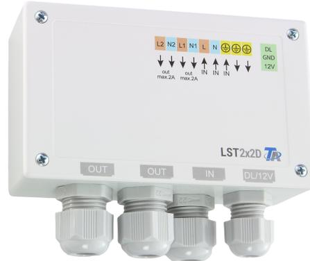
El regulador de potencia atenuable **LST2x2D-DL** conmuta dos veces por separado una potencia de hasta 400 W (2 x máx. 2 A a 230 V AC). La potencia se modula por **sección de fase**.
