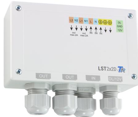
Le contrôleur de puissance dimmable **LST2x2D-DL** commute deux fois séparément des consommateurs d'une puissance maximale 400 W (2 x 2 A max. à 230 V CA). La puissance est modulée par **coupe de phase montante**.
