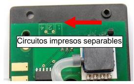
La determinación de la **dirección** se alcanza en el adaptador mediante la separación de circuitos impresos identificados con los números (1), 2 y 4. Estos se encuentran en el borde del lado corto de la platina, cerca del propio sensor de presión. Al adaptador se le asigna la dirección 1 sin separación de circuitos impresos (ajuste de fábrica). En tanto no se encuentren otros sensores en el bus DL, no es necesaria ninguna modificación de la dirección.
