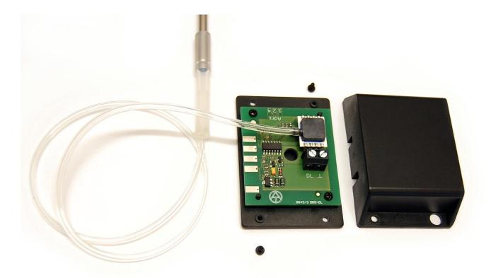
El sensor de presión diferencial DDS-DL se basa en el principio de dos membranas de silicio dispuestas formando un ángulo de 90° que se flexionan con la presión diferencial. La resistencia óhmica modificada como consecuencia de la flexión se registra como magnitud de medición. El desalineamiento existente entre las membranas también garantiza una precisión de señal independiente de la posición a presión reducida.
