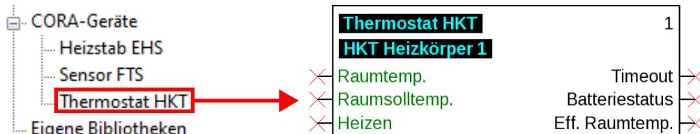
Eine typische Anwendung wäre die Verbindung mit der Ausgangsvariable **Eff. Raumsolltemp.** einer Funktion **Heizkreisregelung** oder einem **Sollwert** einer Funktion **Schaltuhr**.
