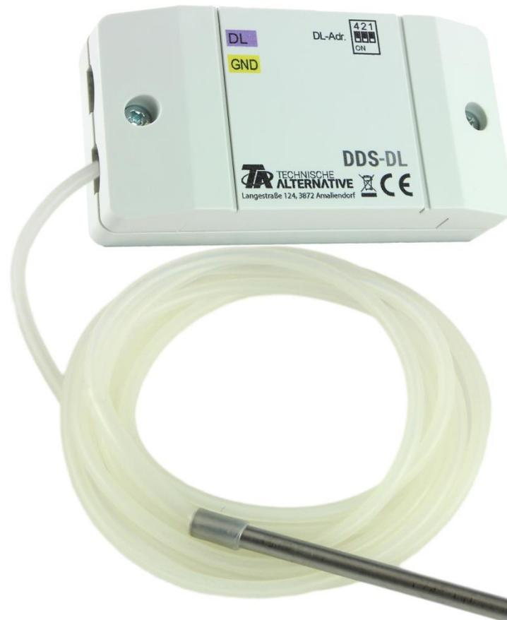
Der Differenzdrucksensor DDS-DL basiert auf dem Prinzip zweier zueinander um 90° verdrehter Silizium- Membrane, die sich im Differenzdruck durchbiegen. Der in Folge der Durchbiegung verändernde ohmsche Widerstand wird als Messgröße erfasst. Der Versatz der Membranen zueinander garantiert auch bei geringstem Druck eine Lage- unabhängige Signalpräzision.
