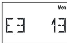
Hier wurde dem externen Sensor **E3** der Sensorwert der **Adresse 1** mit dem **Index 3** zugewiesen, das ist der Differenzdruck mit Mittelwert 64 Sekunden.
