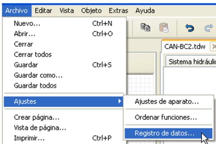
En este menú se definen los parámetros para el registro de datos mediante CAN de valores analógicos y digitales.
