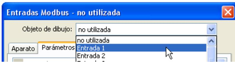
Se pueden programar hasta 64 entradas Modbus. Posteriormente, las entradas Modbus servirán de fuente de las otras salidas de bus, las variables de entrada de funciones, la visualización o el registro de datos.
