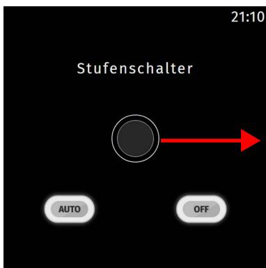
Ist die Basisstufe auf 0 und die Maximalstufe auf 1 gesetzt, wird ein digitaler EIN/AUS Schalter erzielt. In diesem Fall hat die Seite für den Stufenschalter einen Button zum Ein-/Ausschalten.
