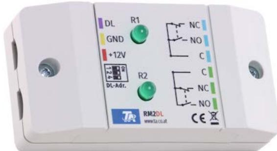
Le **RM2-DL** commute 2 relais sans potentiel via le bus DL. Une alimentation de 12 V (par ex. à partir du bus CAN) est également nécessaire. Les relais ont une puissance de coupure maximale de 5 A. Chaque relais a une LED sur le module qui s'allume lorsque le relais correspondant est commuté (contact à fermeture **NO**).
