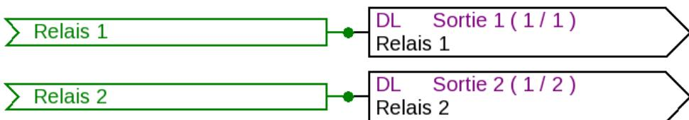
Pour commuter les relais, une sortie DL avec l'index correspondant est paramétrée sur le régulateur.
