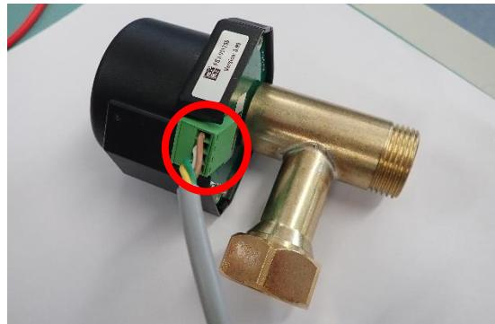
5. Infilare nuovamente il cavo e inserire una nuova fascetta, se necessario. Il nuovo cavo va collegato nello stesso punto. Rimontare e riavvitare il coperchio con l'elettronica.
