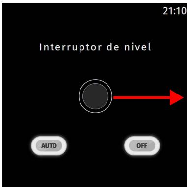
Si el nivel básico está en 0 y el nivel máximo, en 1, se obtiene un interruptor digital de ON/OFF. En este caso, la página para el interruptor de nivel tiene un botón para encender/apagar.
