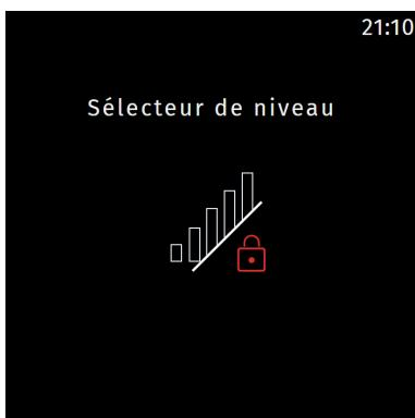
Si l'autorisation du sélecteur de niveau passe en position ARRÊT, les boutons sont masqués et un cadenas apparaît devant les barres.
