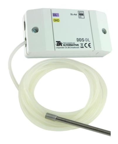
El sensor de presión diferencial DDS-DL se basa en el principio de dos membranas de silicio dispuestas formando un ángulo de 90° que se flexionan con la presión diferencial. La resistencia óhmica modificada como consecuencia de la flexión se registra como magnitud de medición. El desalineamiento existente entre las membranas también garantiza una precisión de señal independiente de la posición a presión reducida.
