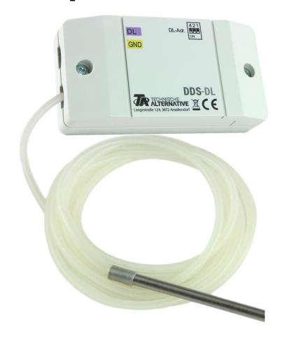
Le fonctionnement du capteur de pression différentielle DDS-DL est basé sur le principe de deux membranes de silicium orientées perpendiculairement l'une par rapport à l'autre et qui se fléchissent sous pression différentielle. La résistance ohmique subissant une modification suite au fléchissement est détectée sous forme de grandeur de mesure. Le décalage des membranes l'une par rapport à l'autre garantit une précision du signal indépendamment de la position, même à une pression très faible.
