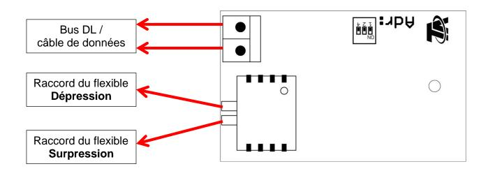
La polarité des raccords du **bus DL** est **interchangeable** et ne doit pas être obligatoirement respectée.
