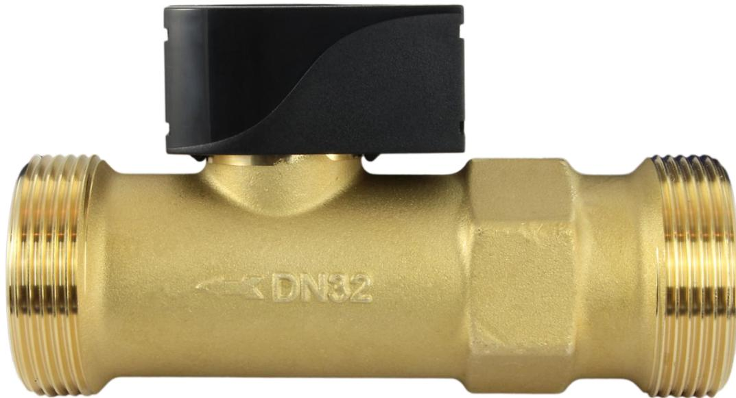
Les capteurs de débit volumique électroniques FTS...DL fonctionnent selon le principe de l'allée de tourbillons alternés de Karman. Le détachement de tourbillons au niveau de l'obstacle situé dans le flux est strictement proportionnel à la vitesse du flux. Les tourbillons générés sont détectés par une palette piézoélectrique et exploités par l'électronique intégrée. Un microprocesseur transforme les valeurs de mesure analogiques en un signal numérique sériel adapté au bus DL (câble de données).
