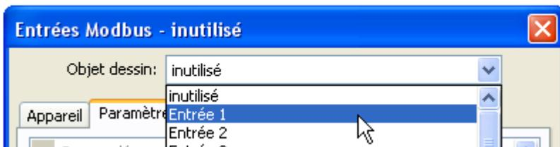
Il est possible de programmer jusqu'à 64 entrées Modbus. Par la suite, les entrées Modbus sont disponibles comme source pour les autres sorties de bus, les variables d'entrée de fonction, la visualisation ou l'enregistrement de données.
