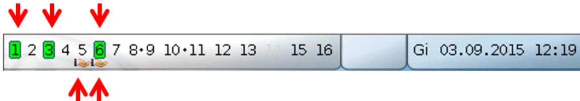
L'uscita 5 è stata **disattivata** manualmente (Manuale/OFF), mentre l'uscita 6 è stata **attivata** manualmente (Manuale/ON). Le uscite impostate su Manuale/OFF o Manuale/ON sono contraddistinte dall'**icona di una mano** visualizzata sotto i rispettivi numeri di uscita.
