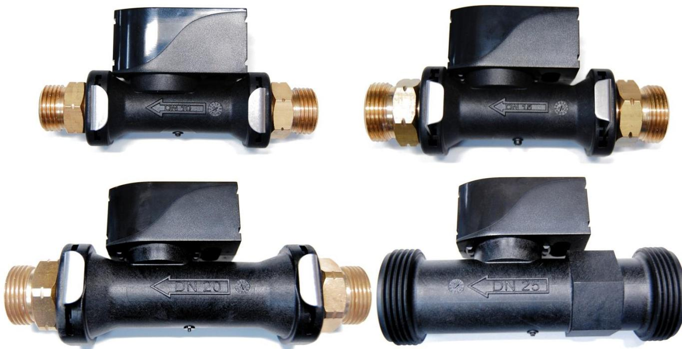
Les capteurs de débit volumique électroniques FTS...DL fonctionnent selon le principe de l'allée de tourbillons alternés de Karman. Le détachement de tourbillons au niveau de l'obstacle situé dans le flux est strictement proportionnel à la vitesse du flux. Les tourbillons générés sont détectés par une palette piézoélectrique et exploités par l'électronique intégrée. Un microprocesseur transforme les valeurs de mesure analogiques en un signal numérique sériel adapté au bus DL (câble de données).
