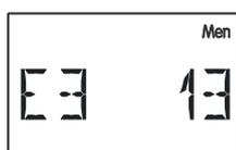
Dans cet exemple, le capteur externe **E3** s'est vu remettre la valeur de capteur de l' **adresse 1** avec l' **indice 3**, il s'agit de la valeur d'un capteur de température PT1000 qui est relié au capteur FTS.
