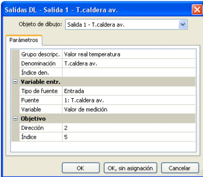
La variable de entrada de la salida DL debe ser un valor numérico **analógico**.
