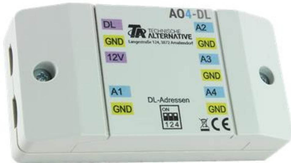
El módulo **AO4-DL** («AO» = analogue output) permite disponer de 4 salidas analógicas adicionales para aparatos con tecnología X2 (p. ej., UVR16x2, RSM610, CAN-I/O45).
