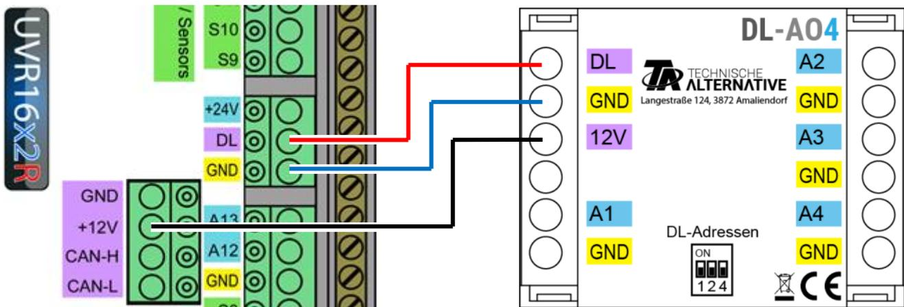
Los fundamentos del cableado del bus DL se explican exhaustivamente en las instrucciones de montaje de los reguladores de programación libre.
