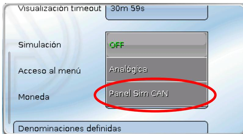
En una red CAN se adoptan las temperaturas simuladas de **todos** los aparatos X2 en los que la simulación está ajustada en «**Panel Sim CAN**».
