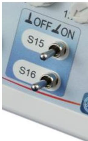
Con ayuda de los dos **conmutadores** para las **entradas 15 y 16**, estas entradas se pueden simular como entradas analógicas de temperatura o como entradas digitales **en función de la programación**.
