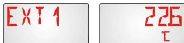
Temperaturanzeige am Externen Sensor 1, „EXT1“ und „22,6°C“ blinken abwechselnd.
