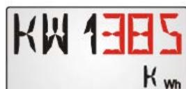
Gezählte Wärmemenge des Wärmemengenzählers 1 in kWh. Bei dreistelligen Anzeigen blinken „KW1“ und der Wert „385“ abwechselnd.
