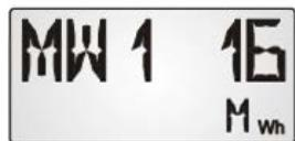
Gezählte Wärmemenge des Wärmemengenzählers 1 in MWh.
