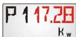
Aktuelle Leistung des Wärmemengenzählers 1 in kW. Bei 4-stelligen Anzeigen blinken „P1“ und der Wert „17,28“ abwechselnd.
