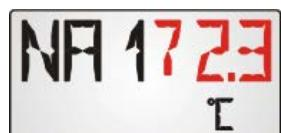
Aktueller Wert des analogen Netzwerkeinganges 1. Bei 3-stelligen Werten blitzen „NA1“ und der Wert „72.3“ abwechselnd.
