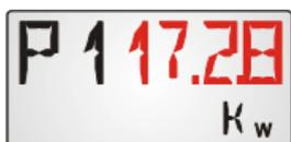
Puissance actuelle du calorimètre 1 en kW. Lorsque l'affichage se compose de 4 chiffres, « P1 » et la valeur « 17,28 » clignotent alternativement.
