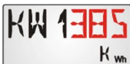
Quantité de chaleur comptée du calorimètre 1 en kWh. Lorsque l'affichage se compose de 3 chiffres, « KW1 » et la valeur « 385 » clignotent alternativement.
