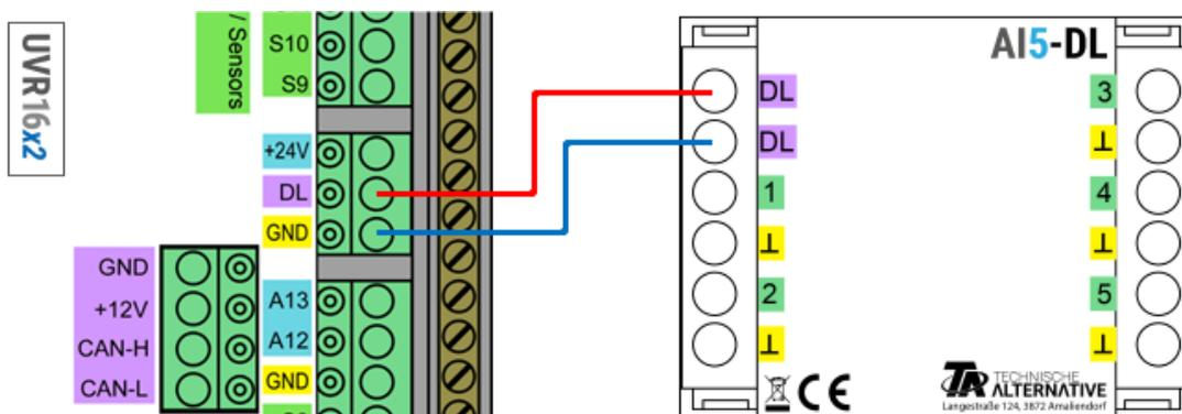
Le basi del cablaggio del bus DL sono descritte in dettaglio nelle istruzioni di montaggio dei tre regolatori programmabili. L'assegnazione dei poli della linea dati è intercambiabile.
